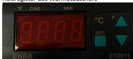
3. Die Einschalttemperatur der Lüfter beträgt ca. 60°C, sobald die Temperatur auf 30°C gesunken ist schalten sich die Lüfter selbstständig wieder aus.
