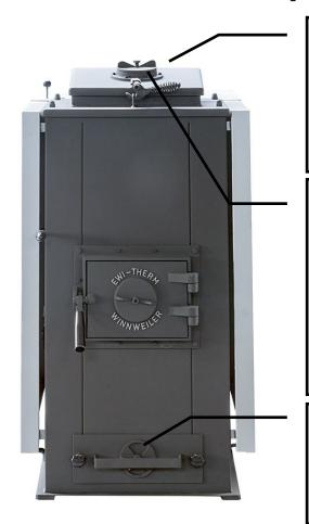
Die zweite Klappe befindet sich zwischen Einfüllöffnung und dem Warmluftauslass. Nach erfolgreichem anzünden des Feuers muss diese Öffnung vollständig geöffnet werden.
