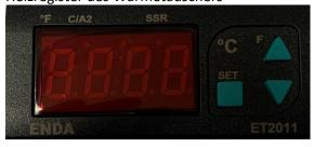
3. Die Einschalttemperatur der Lüfter beträgt ca. 60°C, sobald die Temperatur auf 30°C gesunken ist schalten sich die Lüfter selbstständig wieder aus.
